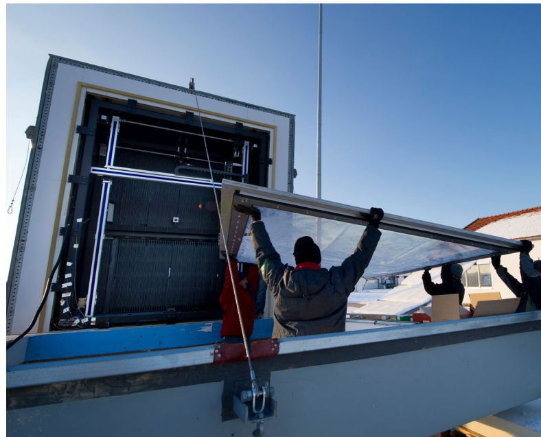
Einbau eines mehrlagigen Membranprüflings © Fraunhofer IBP
