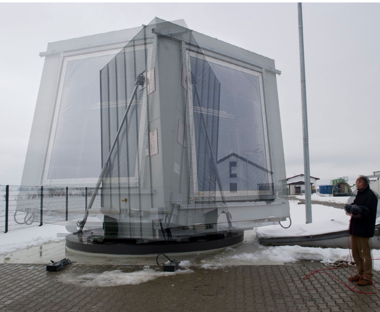
Dreh- und kippbare Prüfkammer mit horizontaler Rotationsmöglichkeit zur Untersuchung des Prüfkörpers in beliebiger Himmelsrichtung © Fraunhofer IBP
